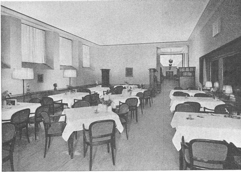
Fig. 8. — Bon éclairage d'un restaurant au moyen de réflecteurs à miroir dissimulés dans les portemanteaux et au moyen de lampadaires ouverts en haut.
