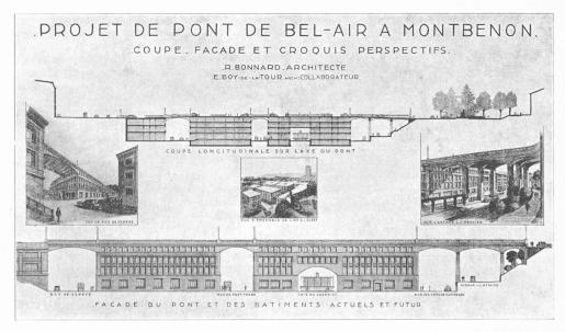
Fig. 2. — Coupe longitudinale : échelle 4 : 2400. Façade : échelle 1 : 1200.
