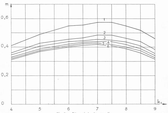
Fig. 2. — Déversoir à crête arrondie. Variation du coefficient de débit, m, en fonction de  $K_1=\frac{h_1}{H}$  et de  $\rho_1=\frac{R_1}{H}$  1)  $\rho=0.5$  2)  $\rho=1$  3)  $\rho=1.5$  4)  $\rho=2$  5)  $\rho=3$  6)  $\rho=4$
