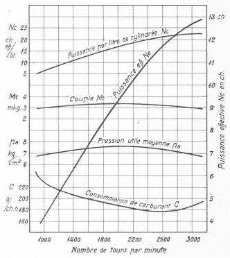
Caractéristiques du moteur Diesel rapide, de F. Oberhänsli & Cie. Nota: au lieu de « carburant », lire « combustible ».
