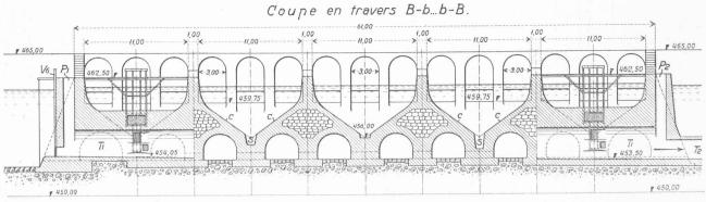
Fig. 3. — Coupe en long et coupe en travers du dessableur de Ponte all' Isarco. Echelle 1 : 400.
