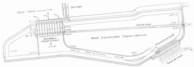
Fig. 1. — Plan général du bassin d'accumulation de 300 000 m³, du dessableur et du canal de secours. Echelle 1 : 2500.
