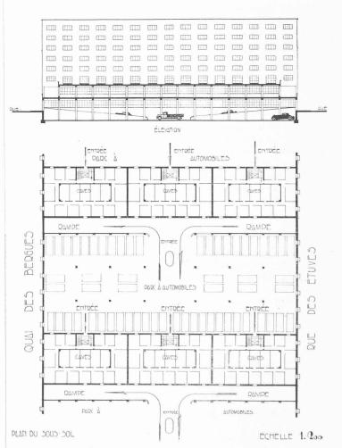
Fig. 4. — Plan et coupe indiquant les particularités des parcs à autos, en sous-sol.
