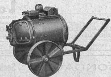
La soudure autogène électrique par courant continu
