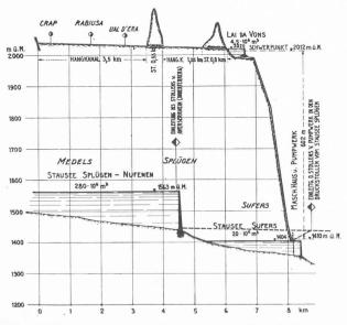
Fig. 6. — Centrale auxiliaire de Lai da Vons-Sufers. Echelles, verticale 1:37500; horizontale 1:375000.
