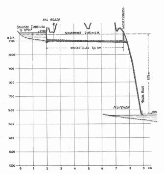
Fig. 5. — Centrale auxiliaire de Curciusa-Nufenen. Echelles, verticale 1:37500, horizontale 1:375000.
