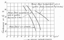
Fig. 6. — Teneur en acide carbonique et en oxygène des gaz d'échappement.
