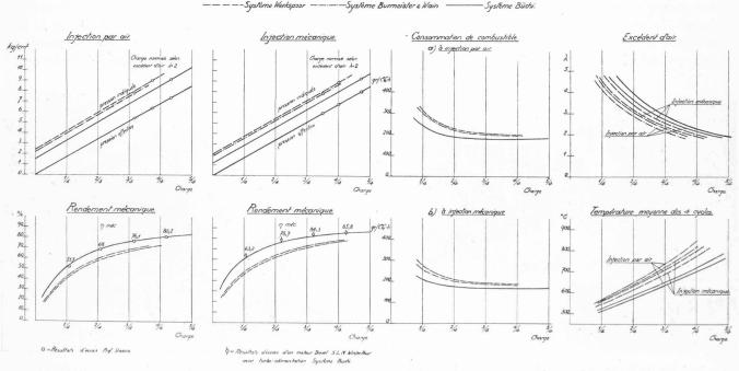
Fig. 5. — Comparaison de différents systèmes de suralimentation.
