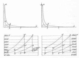
Fig. 1. — Brevet Büchi, 1905. Diagrammes relatifs à un cycle à volume constant (à gauche) et à un cycle à pression constante (à droite).
