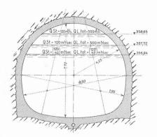
Fig. 3. — Profil en travers-type de la galerie de fuite. Echelle 1: 200.
