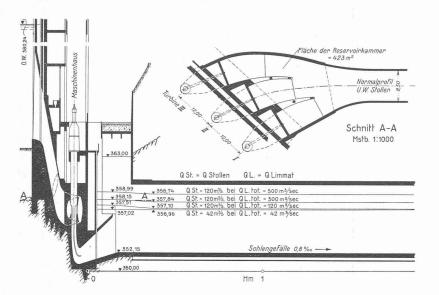
Fig. 2. — Profil en long déformé de la galerie de fuite (longueurs 1:2000, hauteurs 1:400) et coupe horizontale AA par la chambre d'équilibre  $\cdot \quad (\mathbf{F}=423 \ \mathbf{m}^2) \quad \text{Echelle } 1:1000.$
