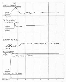
Fig. 5. — Diagramme multiple, enregistré au chronographe d'Amsler sur le modèle, lors d'une ouverture des 3 turbines (Qr = 0 à 120 m³: s) en 5 sec., par une crue exceptionnelle de la Limmat ( $Q_L = 500$  m³: s).
