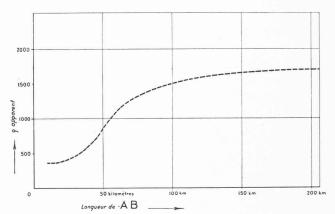
Fig. 14. — Sondage électrique de Vitré poussé jusqu'à une distance des pôles  ${\rm AB}=200~{\rm km}.$
