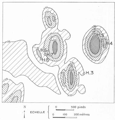
Fig. 12. — Carte du toit des calcaires missisipiens sous les schistes pensylvaniens dessinée d'après les mesures électriques. Les courbes de niveau sont cotées en pieds par rapport à la surface d'une plaine, prise comme plan de référence. H<sub>1</sub>, H<sub>2</sub>, H<sub>3</sub>, sont des sondages de vérification.
