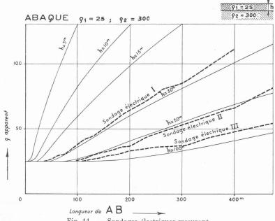
Fig. 11. — Sondages électriques mesurant l'épaisseur de schistes pensylvaniens qui recouvrent des calcaires mississipiens.
