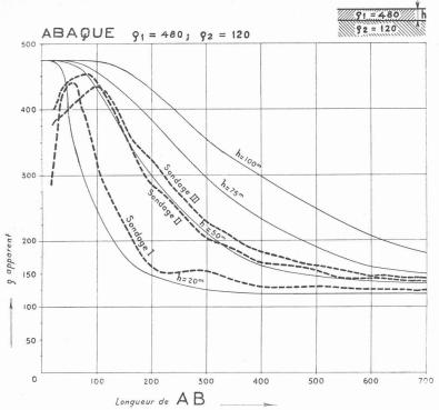
Fig. 9. — Mesure de l'épaisseur de calcaires de résistivité  $\rho_1=450$  à 500 ohms m²/m reposant sur des marnes de résistivité  $\rho_2=120$  ohms m²/m. Les trois sondages électriques (en pointillés) sont reportés sur leur abaque théorique  $\rho_1=480$ ;  $\rho_2=120$ .
