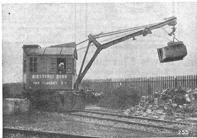
Grue pivotante de 3 tonnes pour service avec électro-aimant et avec benne preneuse automatique. Commande par moteur Diesel.
