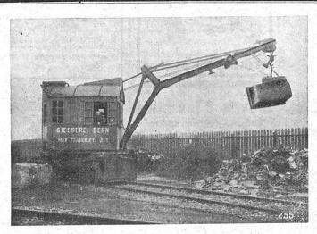
Grue pivotante de 3 tonnes pour service avec électro-aimant et avec benne preneuse automatique. Commande par moteur Diesel.
