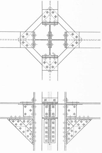
Fig. 6. — Assemblage des poutres horizontales avec les colonnes.
