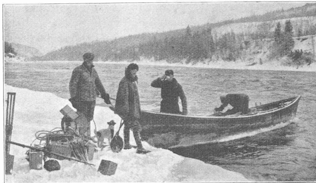
Fig. 6. — Débarquement de prospecteurs qui vont mesurer l'épaisseur des alluvions d'une rivière canadienne. Le matériel électrique nécessaire, que l'on voit sur la gauche, ne pèse que 60 à 80 kg.
