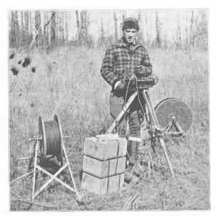
Exécution d'un sondage électrique. L'opérateur est à l'appareil de mesure. Devant lui trois batteries de piles sèches pesant chacune 12 kg. Le câble en réserve sur les deux bobines va permettre d'éloigner progressivement les pôles A et B.
