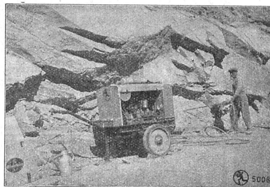
Moto-compresseur roulant LZ 20, pour 1 marteau, se distingue par sa légèreté et sa grande mobilité en même temps que sa grande robustesse.
