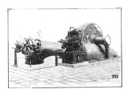
Une des turbines PELTON de 18 000 ev., 750 t/m pour une chute de 780 m. — Centrale du Lac d'Oo (France).
