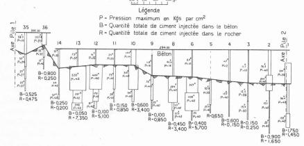
Barrage de Pinet, sur le Tarn. Représentation des pertes d'eau par forages et absorption par mètre linéaire de ciment.
