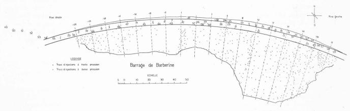
Barrage de Barberine. Plan des injections du voile normal et des injections de liaison.
