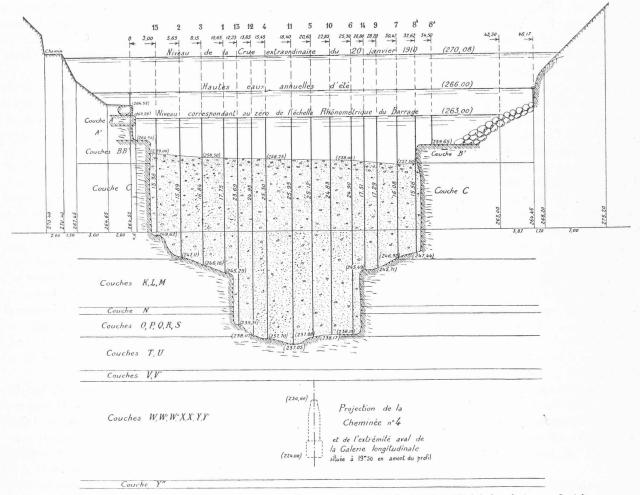
Barrage de Génissiat, sur le Rhône. Sondages aux rails avec projection de la cheminée Nº 4 de la galerie sous-fluviale.
