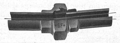
La jonction de tubes qui ne sont pas situés dans le prolongement l'un de l'autre, qui ont des filetages inclinés ou qui doivent être raccordés suivant une ligne brisée, constitue un problème que le « raccord Mac » résoud de manière simple et élégante, permettant un désaxement jusqu'à 6°. Comme tous les raccords +GF+, il est éprouvé à l'usine à la pression hydraulique.
