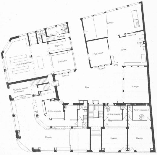
Fig. 10. — Plan du rez-de-chaussée du nouveau bâtiment de la Société romande d'électricité, à Vevey. — Echelle 1 : 250.
