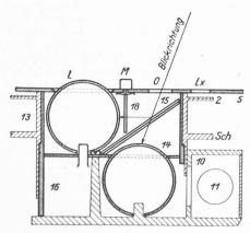
Fig. 5. — Schéma du dispositif de mesure du luxmètre Osram. (Même légende que la figure 2.)
