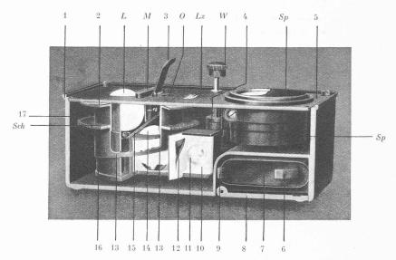
Fig. 2. — Vue en coupe du luxmètre Osram.
