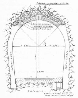
Fig. 5. — Tunnel de Glovelier. Nouveau profil normal. Echelle 1: 100.
