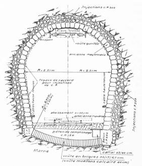
Fig. 3. — Ancienne maçonnerie, avec nouveau radier. Echelle 1 : 100.
