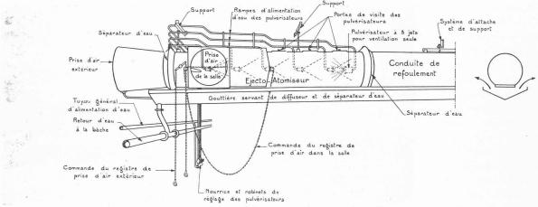
Fig. 2. — Schéma d'un éjecto-atomiseur Neu.
