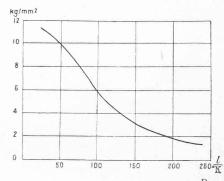
Graphique donnant le maximum de  $\frac{P}{s}$  (P= charge suivant l'axe de la pièce, s= section de la pièce) en fonction de  $\frac{l}{K}$  pour  $R_c=29,25~{\rm kg/mm^2}$ .
