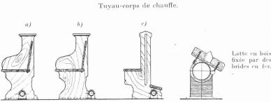
Schéma du système de chauffage électrique par banquettes. emplacement du corps de chauffe pour faible espacement des bancs. grand espacement des banes. banes avec prie-Dieu.
