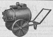
La soudure autogène électrique par courant continu
