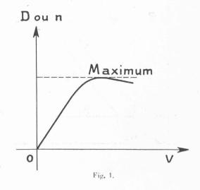
convoi, c'est-à-dire du poids transporté P; ce qui accentue le maximum de D, conformément à la figure 1. La présence d'un maximum de n, en fonction de v, est particulièrement apparente dans la circulation des automobiles sur des chaussées à sens unique. Les entreprises de transport peuvent viser encore autre chose qu'un maximum de D: ce sera, par exemple, un maximum de v, ou de  $P_{u}$ , dans certains secteurs, ou, seulement, la réalisation d'un trafic régulier, sans acception de maximum.
