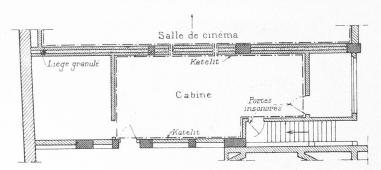
Fig. 6. — Isolation de la cabine de l'opérateur.
