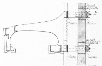
Fig. 4. - Attache et isolation des corniches lumineuses.
