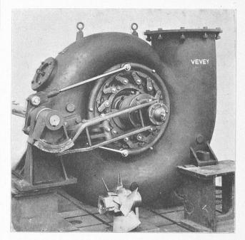
Turbine Kaplan, à bâche spirale. Au premier plan : roue motrice avec mécanisme d'orientation breveté.
