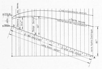
Fig. 7. — Repartition du coup de bélier suivant la longueur de la conduite sans chambre d'air.
