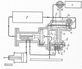
Fig. 2. — Processus de desserrage.
