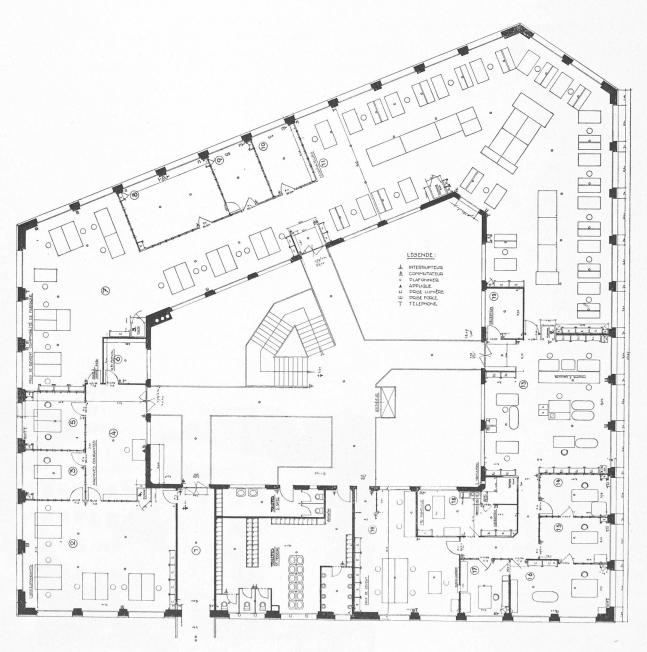
Fig. 1. — Plan du 1er étage des Bureaux de la Société Nestlé. Echelle 1 : 175.  $A,\ B,\ C.\ E,\ Ec,\ V=\text{armoires}.$
