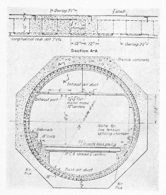
Fig. 41. — Tunnel à Détroit. Coupe transversale type de tronçon construit par flottage,
