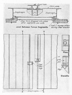
Fig. 40. — Tunnel à Détroit. — Détail du joint de deux tronçons de tubes ; oreilles en acier moulé percées de trous destinés à recevoir des broches de 5 pouces. Cast steel lugs = oreilles en acier moulé. — Key = goupille. — Pin = broche.
