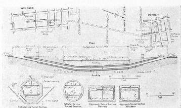
Fig. 1. — Tunnel à Détroit, Plan, profil en long et coupes transversales.
