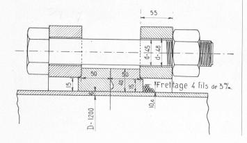
Diamètre intérieur : 1,20 m. Epaisseur de la tôle : 6 mm.
