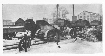
Fig. 1. — Voiture de tourisme Saurer, de 50 ch, transformée pour le service sur rails. Le disque appuyé à un poteau, à gauche de la photographie, fut utilisé, en février 1908, en guise de boudin, pour le trajet de montagne Rorschach-Heiden.
