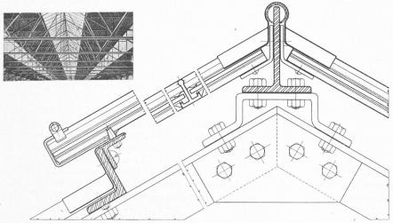
Fig. 13. - Vitrage d'un toit.
