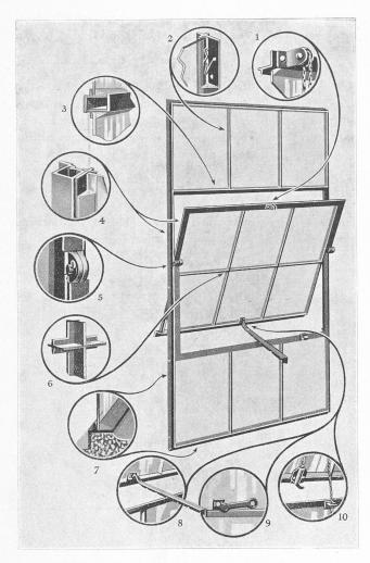
Fig. 7. — Fenêtre métallique à panneaux pivotants autour d'un axe médian.
