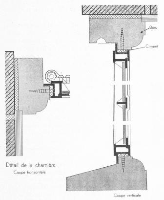
Fig. 10. — Fixation des cadres dormants à des châssis en bois.
