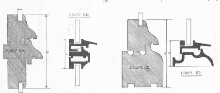
Fig. 1. — Comparaison d'une fenêtre en bois et d'une fenêtre métallique.
