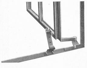
Fig. 9. — Fenêtre s'ouvrant à l'extérieur et pivotant autour d'un axe non situé dans son plan.
