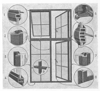
Fig. 6. — Fenêtre métallique à panneaux pivotants.
