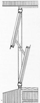
Fig. 8. - Fenêtre à 2 panneaux à ouvertures partielles.
