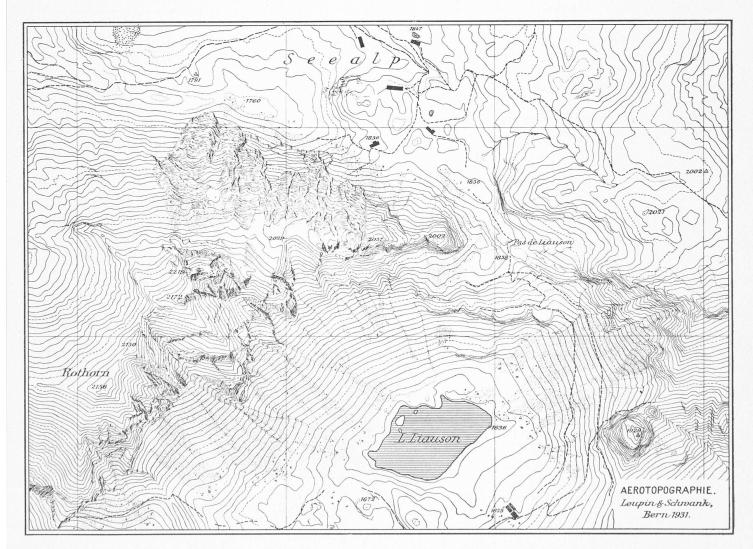
Fig. 6. — Plan aérotopographique. Echelle 1: 10 000. — Equidistance 10 m. Rochers représentés par des hachures et par des courbes de niveau.
