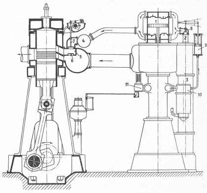
Fig. 4. — Moteur Diesel-Sulzer à deux temps avec compresseur de suralimentation.
