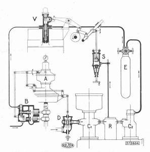
Fig. 5. — Schéma du nouveau réglage des moteurs Sulzer stationnaires, à deux temps, de grande puissance.
