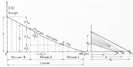
Fig. 2. — Diagramme de l'énergie maximum réalisable.
