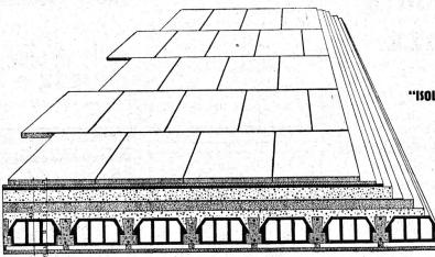
"ISOLAPHON" - Flachdachkonstruktion
