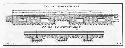
Fig. 1. — Pose de voies sur béton.
