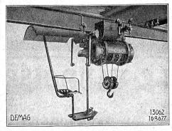
Palan Demag avec siège de conducteur accouplé
