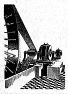
Economie de force motrice. Diminution de traction. Pas de pertes par glissement. Rend inutile les enrouleurs sans augmenter la distance entre les axes.
