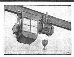
Chariot Demag avec cabine fermée pour chemin de roulement avec courbe.
