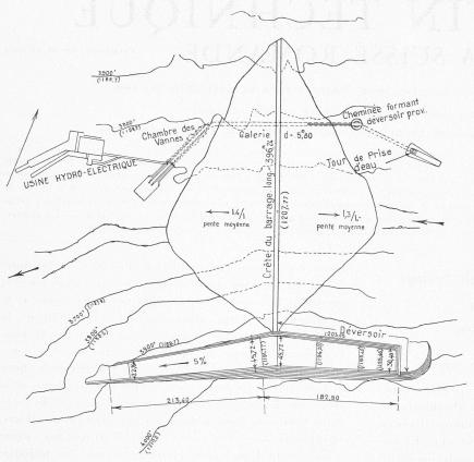
Fig. 1. — Vue en plan du barrage, avec ouvrages-annexes : déversoir, déri-ation, prise d'eau, etc.
