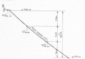
Fig. 6. — Section verticale du barrage montrant la courbure.
