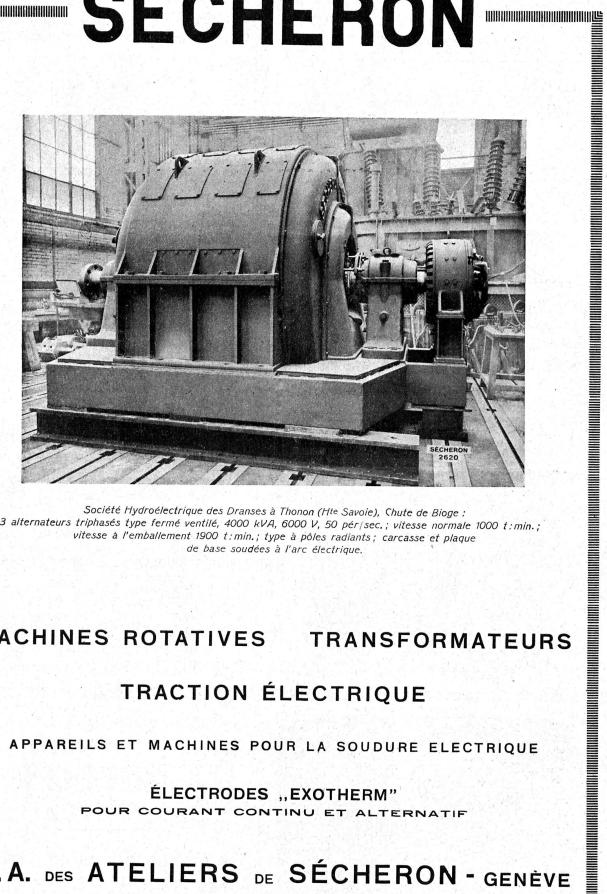
Société Hydroélectrique des Dranses à Thonon (Hte Savoie), Chute de Bioge : 3 alternateurs triphasés type fermé ventilé, 4000 kVA, 6000 V, 50 pér/sec.; vitesse normale 1000 t:min.; vitesse à l'emballement 1900 t:min.; type à pôles radiants; carcasse et plaque de base soudées à l'arc électrique.
