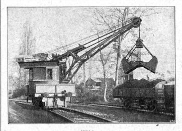
Wildegg Grue pivotante de 3 tonnes, avec benne preneuse de 1,25 m³, alimentée par accumulateurs.
