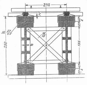
Fig. 20. — Pont système Lembke.
